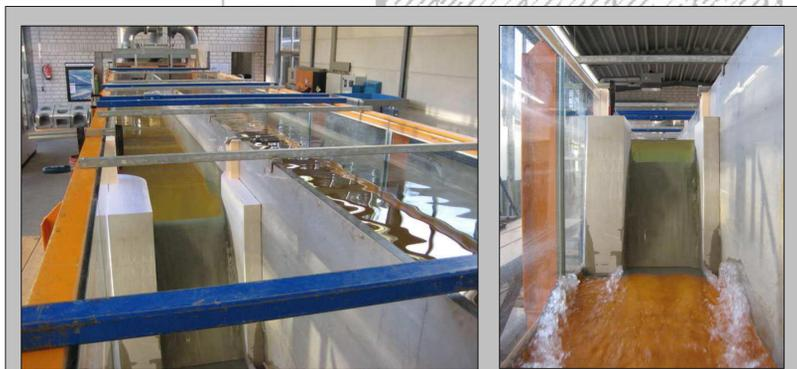
Strömungskanal im Labor für Wasserbau mit eingesetztem Modell der Mauerkrone
