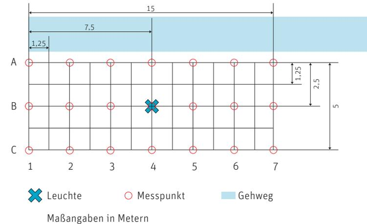
Um vergleichbare Messbedingungen zu schaffen, wurde im Vorfeld der Messungen, ein Messfeld, mit einer Länge von 15 m und einer Breite von 5 m festgelegt. Zu diesem Messfeld ist, zur Messung der Beleuchtungsstärke, das Rechenraster (schwarzes Gitternetz) nach Norm [DIN12193] berechnet worden. Um eine optimale Anzahl an Messpunkten zu
