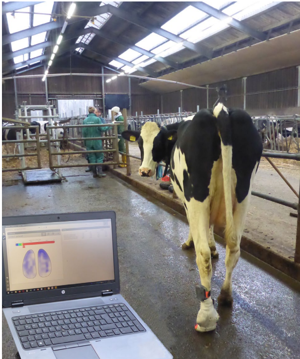
Abb. 2: Messung an der linken Hintergliedmaße, Sensor und Datenlogger sind befestigt. Messdaten werden aufgezeichnet und über WLAN in Echtzeit auf den Laptop übertragen.
