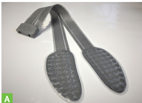
Abb. 1: (A) flexibler, wasserfester Sensor für die Klauen einer Gliedmaße, (B) Sensor mit textilem Befestigungsschuh und Datenlogger an der Gliedmaße.
